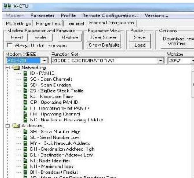
**Gambar 3. 9.** Konfigurasi XBee S2 dengan X-CTU
