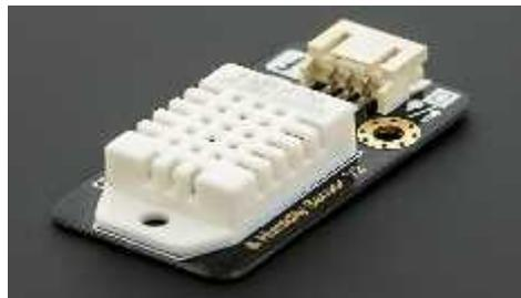
**Gambar 2. 2.** DHT 22 Sensor Suhu dan Kelembaban
