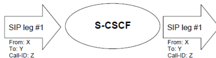
Gambar 2.7. Sebuah SIP melewati S-CSCF tanpa Application Server
