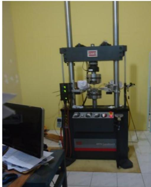
Gambar 21. Mesin uji tarik
