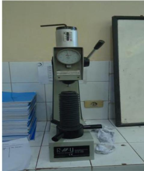
Gambar 23. Alat uji kekerasan *Rockwell*
