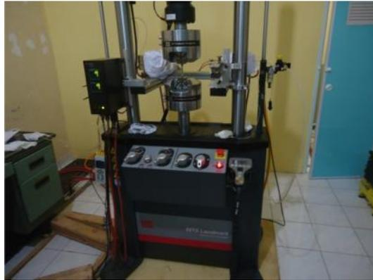
Gambar 12. Mesin Uji Tarik (*Universal Testing Machine*)
