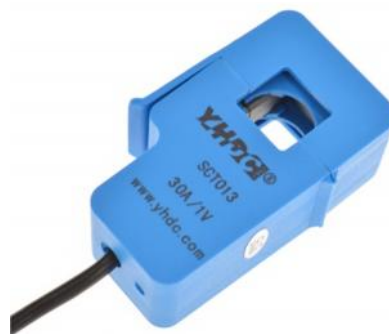
Gambar 27. Current Transformer Sensor SCT013-030 (yhdc.com)
