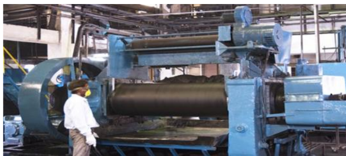
Gambar 2.7. Pencampuran metode otomatis karet alam
