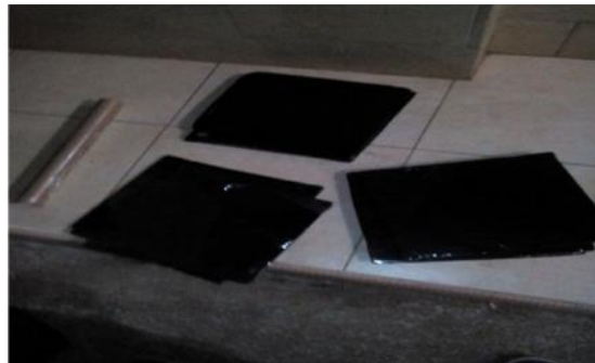
Gambar 3.13. Hasil pencetakan komposit menjadi bentuk kompon
