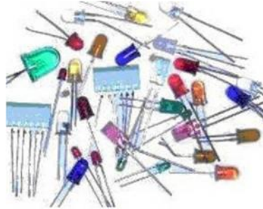
Gambar 2.17 Berbagai Bentuk Lampu LED [Dikutip dari buku “ Dasar-dasar Elektronika ”, Erlangga]
