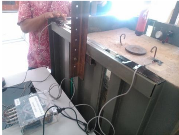
Gambar 16. pengujian penurunan tanah
