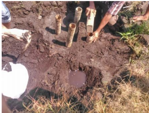
Gambar 4 Pengambilan contoh tanah undisturb
