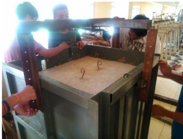
Gambar 15. pemasangan matras beton pada boks uji
