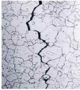
Gambar 2.5. Korosi retak-tegang (sumber: Priyotomo, 2008).
