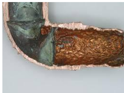
Gambar 2.7. Korosi erosi (sumber: Priyotomo, 2008).
