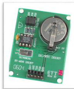
Gambar 2.12 bentuk fisik modul RTC(Real Time Clock)
