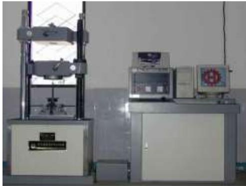
Gambar 2.26 Mesin uji tarik [[elitabmas.itn.ac.id](http://elitabmas.itn.ac.id)].
