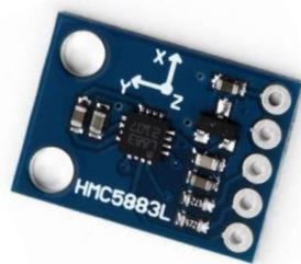
**Gambar 2.7 Sensor kompas HMC5883L (Bowo,2014)**
