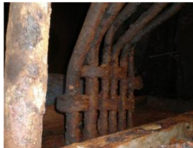
Gambar 2. Korosi seragam pada pipa (ASM Handbook, 1991).
