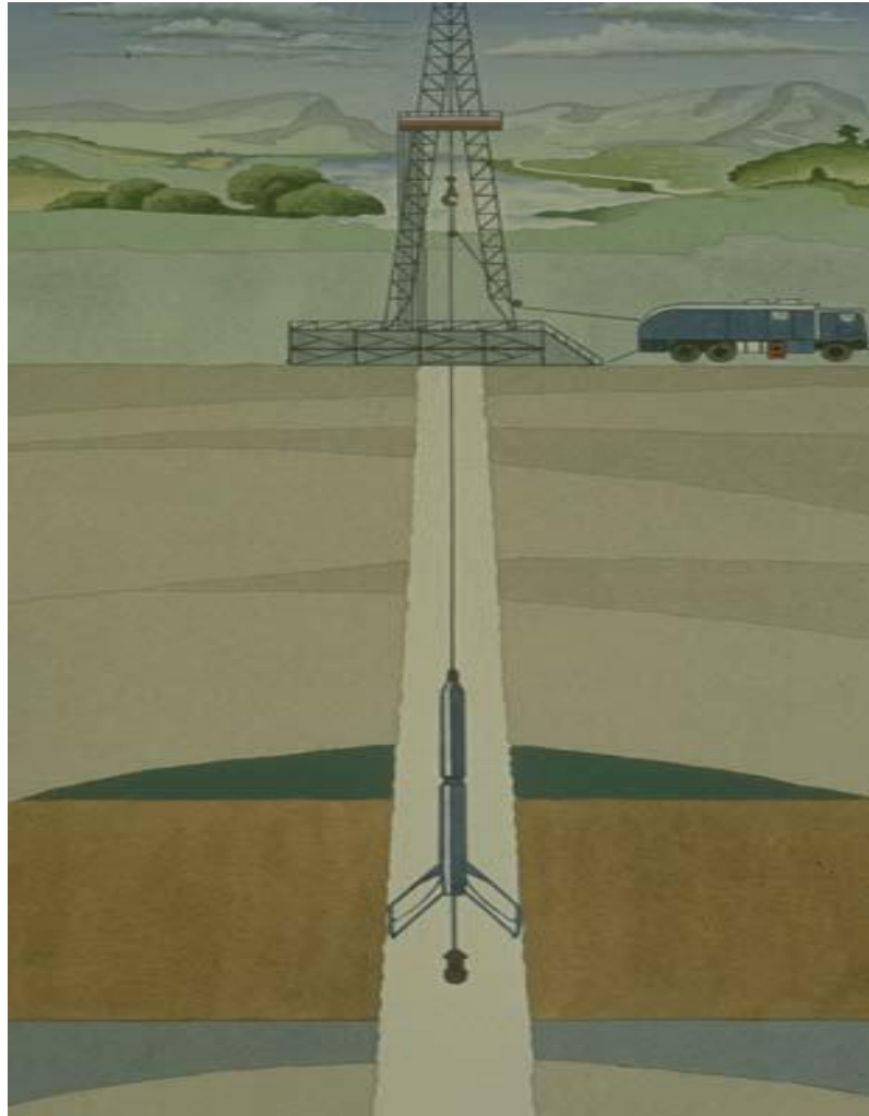
Gambar 9. Pengukuran Wireline Logging sumur eksplorasi
