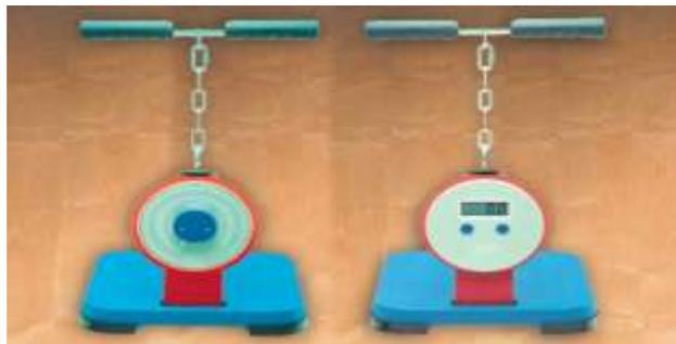
Gambar 12. Alat *Leg Dynamometer*
