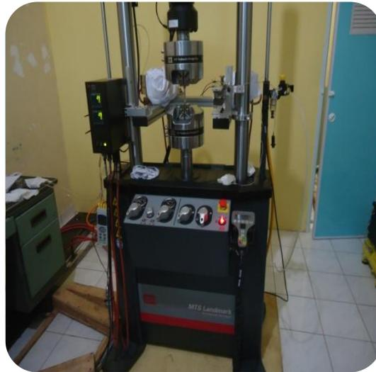
Gambar 11. Mesin Uji Tarik (*Universal Testing Machine*)
