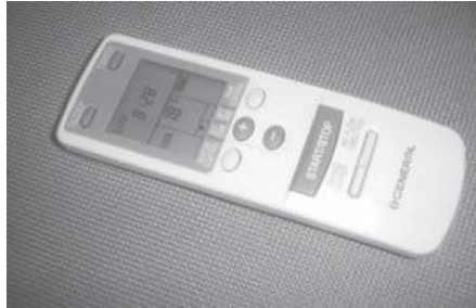
Gambar 7. Remote kontrol menggunakan sinar infra merah
