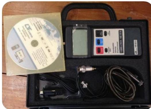
**Gambar 3.7.** Alat ukur getaran (Lutron VB-8213).
