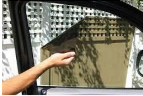
**Gambar 2.2.** Pelapisan film pada kaca mobil (Kurniady, 2014)
