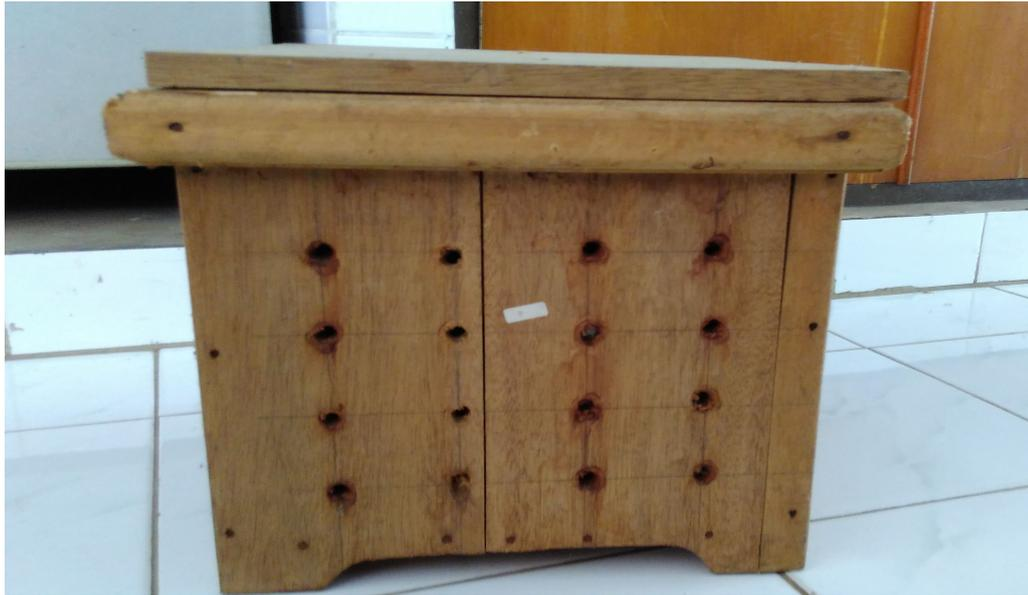
Gambar 2. Kotak fermentasi dari kayu kapasitas 5 kg
