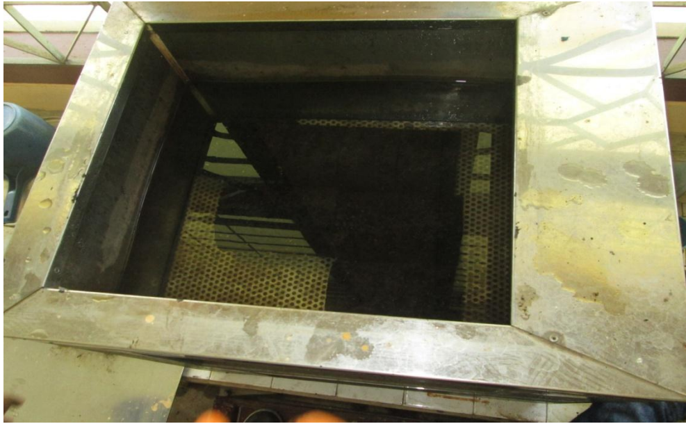
Gambar Proses Perendaman Aspal Beton Di Dalam Water Bath Dengan 60°C Selama 30 Menit
