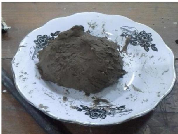
Gambar 23. Campuran zeolit-*fly ash* yang telah kalis.
