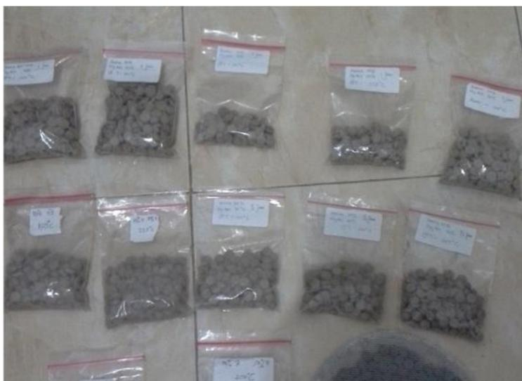
Gambar 25. Pelet zeolit-*fly ash* yang dikemas dalam plastik kedap udara.
