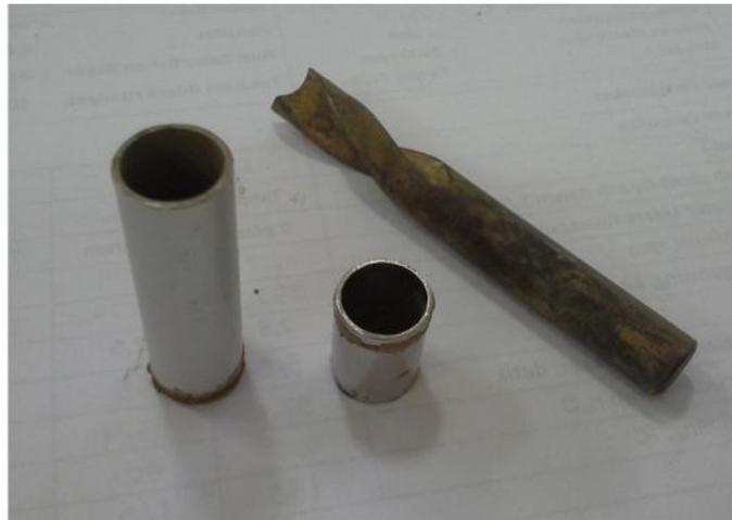
Gambar 14. Cetakan pelet zeolit-*fly ash*.
