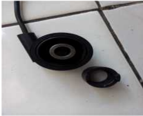
Gambar 2.1. Sensor kecepatan motor Honda CB150R
