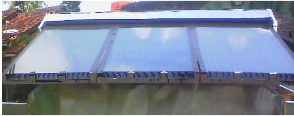
Gambar 9. Kolektor surya setelah terpasang pada alat pengering.
