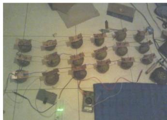
Gambar 2.2. Pengukuran 18 buah mangga secara paralel dengan beban
