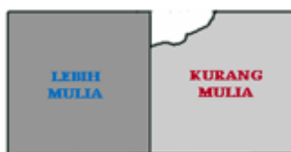
Gambar 2.4. Korosi dwi logam (sumber Priyotomo, 2008).
