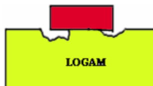
Gambar 2.5. Korosi celah ( crevice corrosion ) (sumber Priyotomo, 2008).
