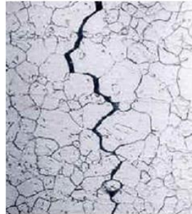
Gambar 2.7. Korosi retak-tegangan (sumber: Priyotomo, 2008).
