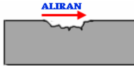
Gambar 2.9. Korosi erosi (sumber Priyotomo, 2008).
