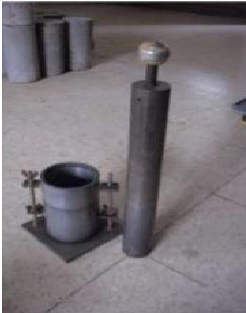
Gambar 1. Alat Pengujian Pemadatan Standar
