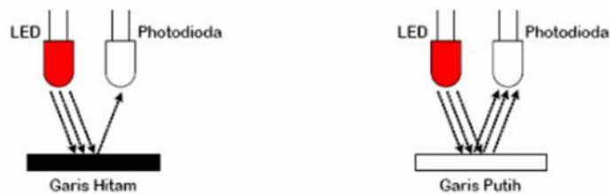
Gambar 2.4 Cara Kerja Photodioda
