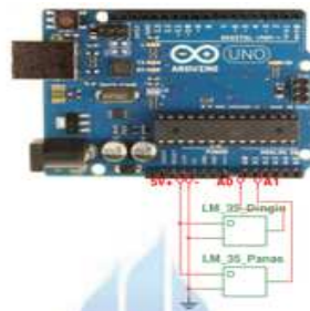
Gambar 3.7. Rangkaian Sensor Suhu LM35 Dengan Arduino Uno ( Anonim 4,2016)
