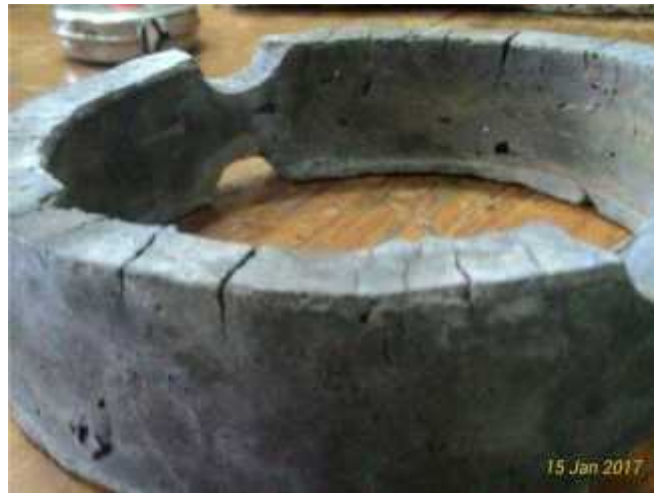
Gambar 4.9 Retakan pada permukaan spesimen C30_3
