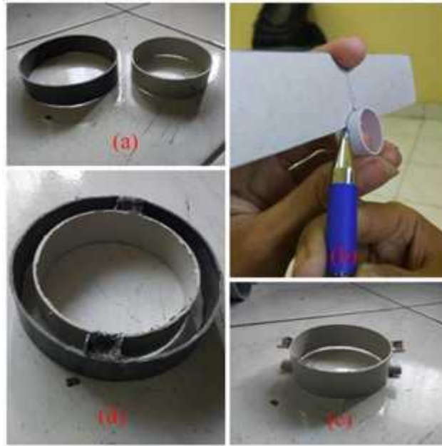
Gambar 3.5 (a) pipa 3 in dan 4 in yang terpotong, (b) Penandaan pada pipa 1 in sebelum dipotong, (c) Pengeleman pipa 1 in dan 3 in, (d) Cetakan pipa
