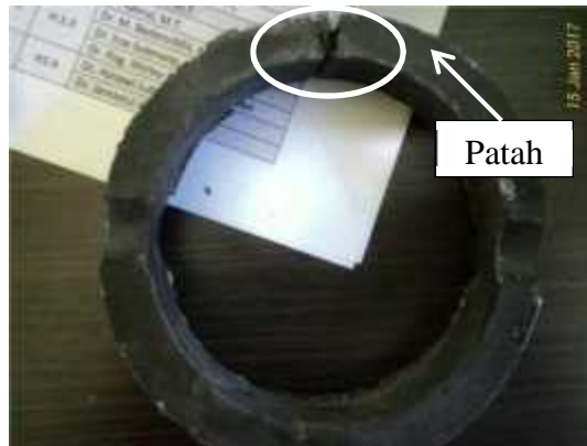
Gambar 4.4 Perpatahan pada spesimen
