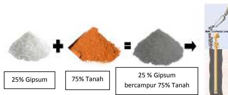
Gambar 3.5 Pengisian 25% gipsum ke lubang pentanahan
