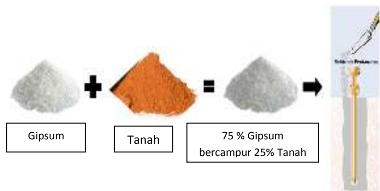
Gambar 3.3 Pengisian 75% gipsium ke lubang pentanahan
