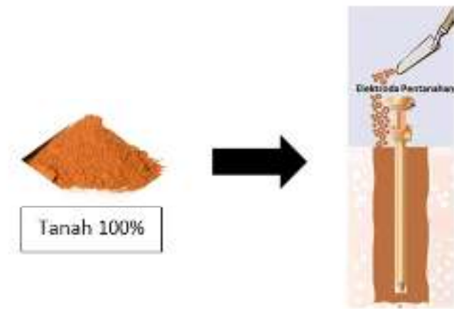
Gambar 3.1 Pengisian tanah ke lubang pentanahan
