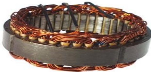
Gambar 2.18. Intistator dan alur pada stator (Dietzel, 1988).
