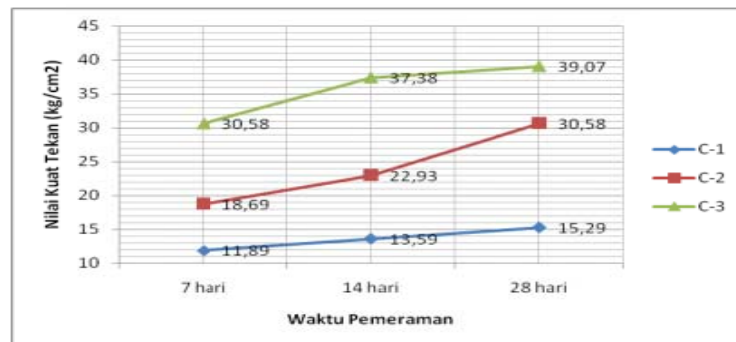
Gambar 3. Hubungan Nilai Kuat Tekan paving block Dengan Waktu Pemeraman.
