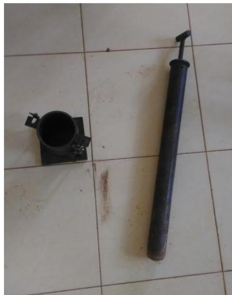
Gambar 1. Alat Uji Pemadatan Tanah *Modified Proctor*
