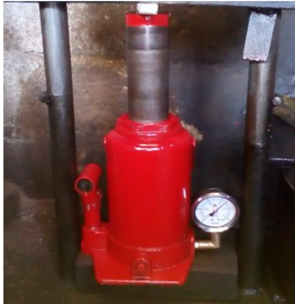
Gambar 3.18. hasil modifikasi dongkrak yang dilengkapi dengan Pressure Gauge
