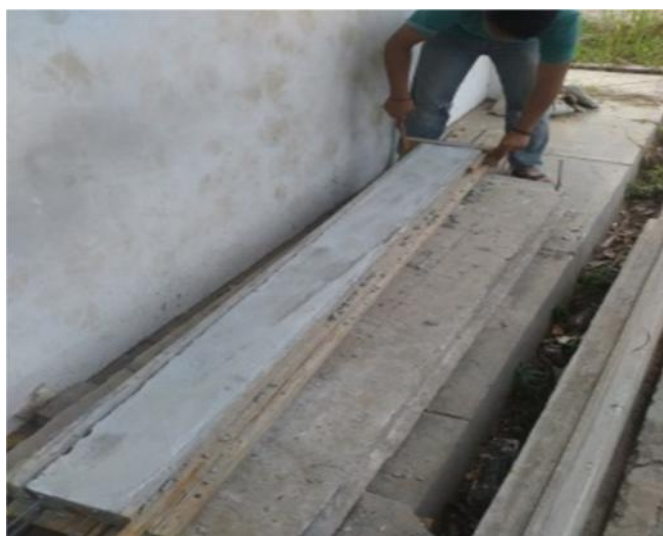
Gambar 3.8. proses pelepasan balok beton profil c dari cetakan
