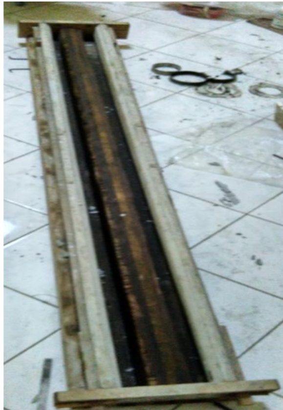
Gambar 3.2. Cetakan balok beton profil c
