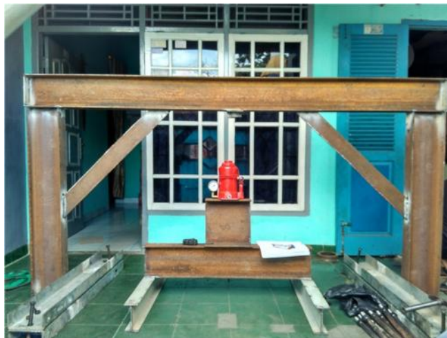
Gambar 3.14. Pemasangan Dongkrak Hidrolik Pada Rangka
