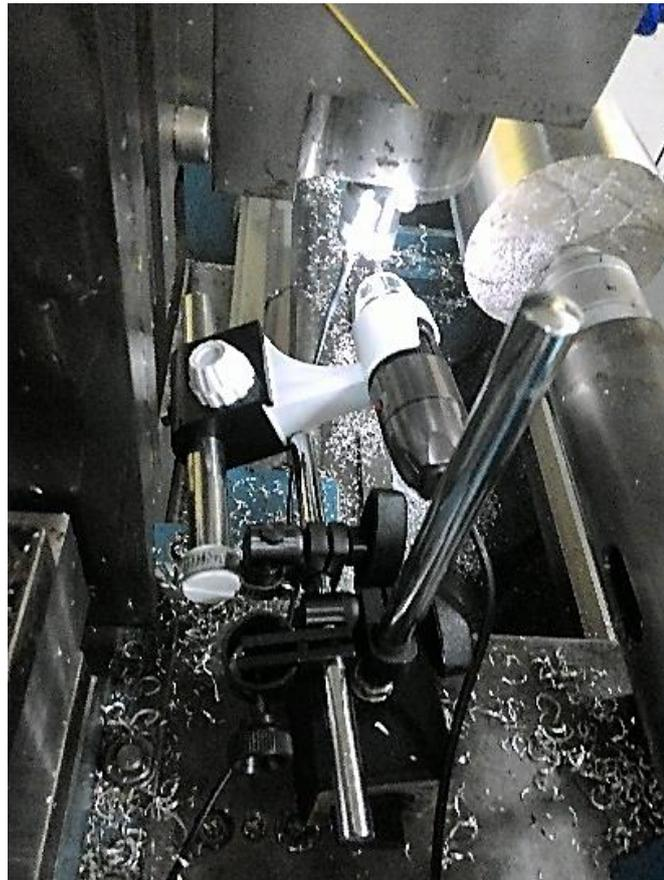
Gambar 3.16 Cara melihat laju keausan menggunakan mikroskop usb
