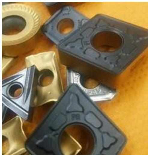
Gambar 2.10 Pahat bubut sisipan (*insert*) ( Sumber : Anonim, 2016)
