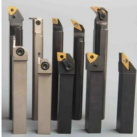
Gambar 2.11 Pahat sisipan yang dipasang pada pemegang pahat (*tool holders*)
