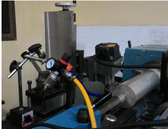
Gambar 3.14 Instalasi *Vortex Tube*
