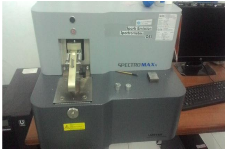
Gambar 16. Optical emission spectrometer spectromax (alat uji komposisi kimia) laboratorium LIPI Tanjung Bintang
