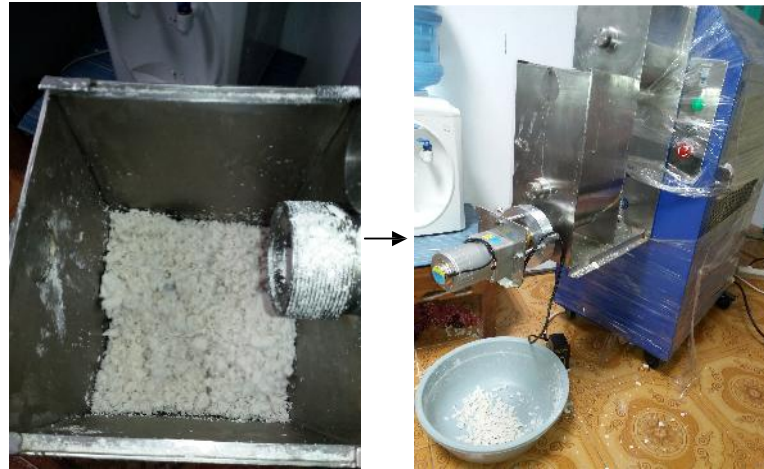
Gambar 13. Proses pencetakan butiran beras analog
