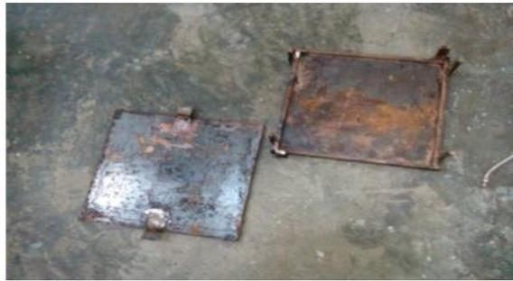
**Gambar 3.11.** Cetakan baja, berfungsi mencetak campuran komposit menjadi lembaran kompon.
