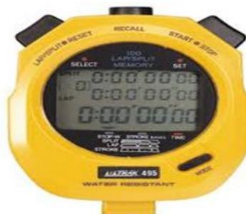
**Gambar 3.8.** *Stopwatch*, berfungsi menghitung waktu proses percampuran dan pengepressan komposit.
