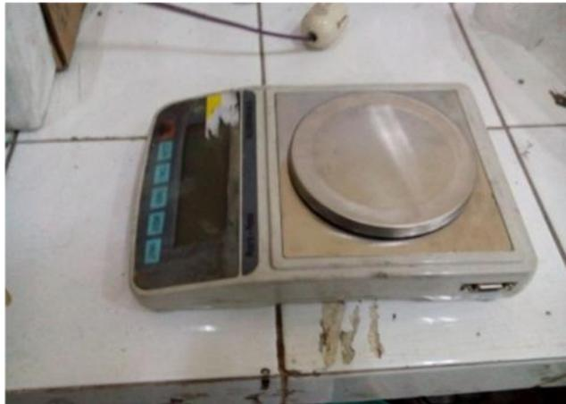
**Gambar 3.7.** Timbangan digital, berfungsi menimbang variasi campuran komposit.
