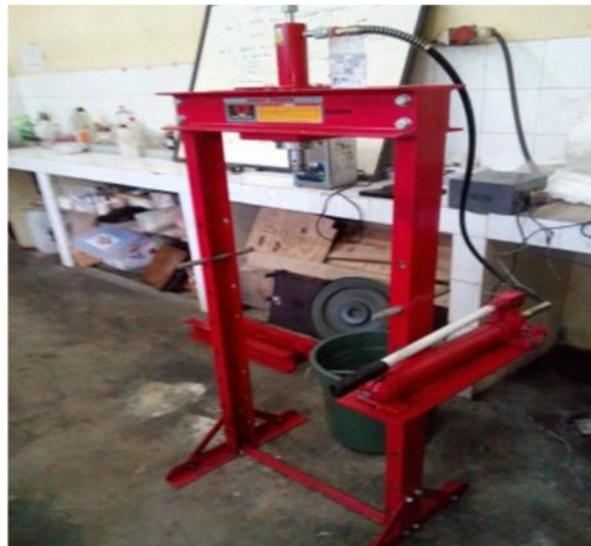
**Gambar 3.10.** Mesin *pressshop* 12 Ton, berfungsi alat pengpressan komposit menjadi lembaran kompon.
