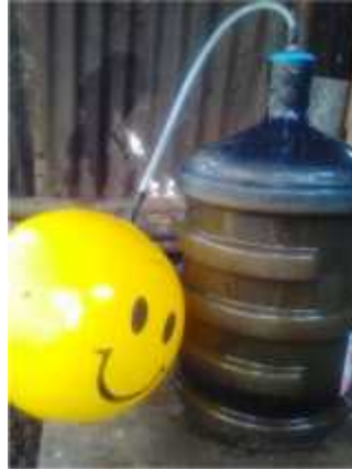
Gambar 6 . Instalasi reaktor biogas skala galon
