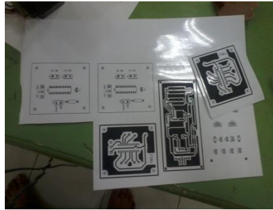
Gambar 27. Kertas foto yang telah dicetak skema rangkaian.
