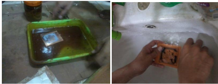
Gambar 29. Proses perendaman pcb ke larutan \text{FeCl}_3 .
