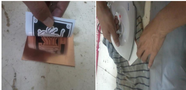
Gambar 28. Langkah-langkah mencetak skema rangkaian ke PCB,
