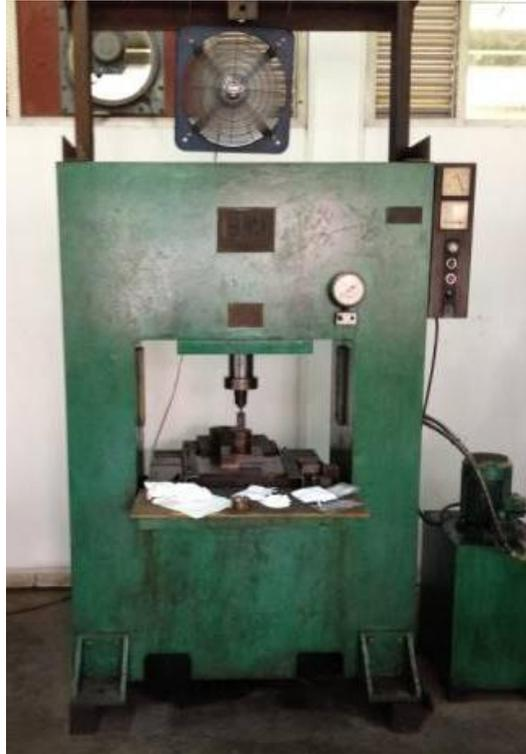
Gambar 3.2.Mesin yang digunakan untuk kompaksi serbuk logam AZ31 yang dipakai.
