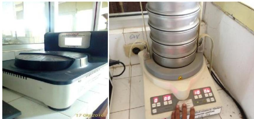
Gambar 3.1. Mesin yang digunakan untuk membuat serbuk dan mengayak serbuk logam AZ31.
