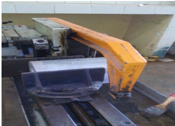
Gambar 3.7 Pemotongan paduan Magnesium AZ31
