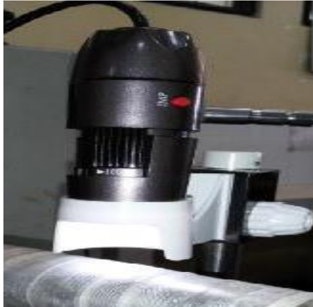
Gambar 3.11 Cara pengambilan Gambar profil permukaan magnesium menggunakan kamera mikroskop USB.
