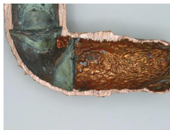
Gambar 7. Korosi erosi (Utomo, 2009).
