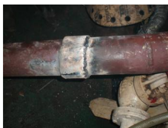
Gambar 3. Korosi galvanik (Utomo, 2009).
