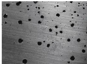
Gambar 5. Korosi sumuran (Utomo, 2009).
