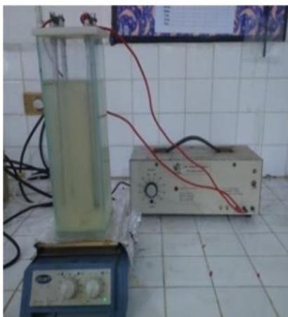
**Gambar 7.** Reaktor elektrolisis
