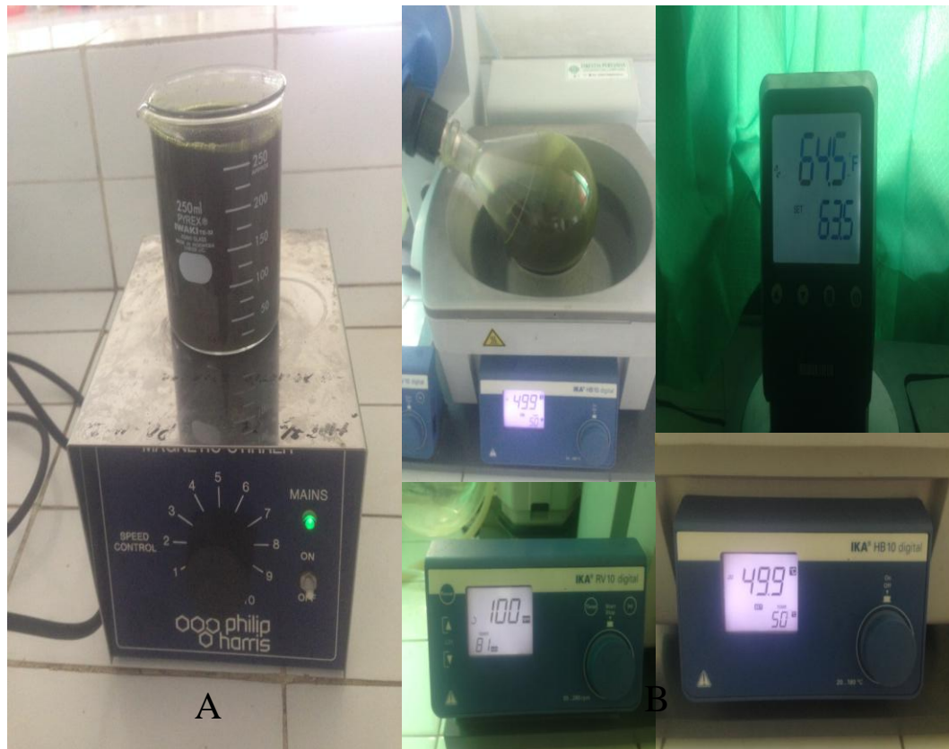
Gambar 3. (A). Proses magnetic stirrer ekstrak daun mengkudu di laboratorium (B). Proses rotary evaporator ekstrak daun mengkudu di laboratorium
