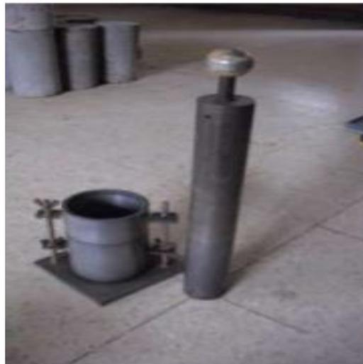
Gambar 1. Alat Pengujian Pepadatan *Standard Proctor*
