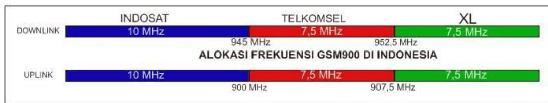
Gambar 2.2 alokasi frekuensi GSM 900 MHz di Indonesia [7]
