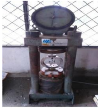
Gambar 2.4. Mesin Pengujian Kuat Tekan (Sumber : Laboratorium Beton Teknik Sipil UNILA).
