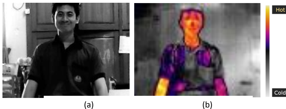
Gambar 2.8 Citra wajah yang ditangkap secara simultan pada (a) spektrum cahaya tampak 0.4-0.7 \mu\text{m} dengan hasil grayscale , (b) longwave infrared 8.0-14.0 \mu\text{m} dengan colormap .
