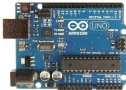
Gambar 2.5. Bentuk Fisik Mikrokontroler Arduino Uno[12]
